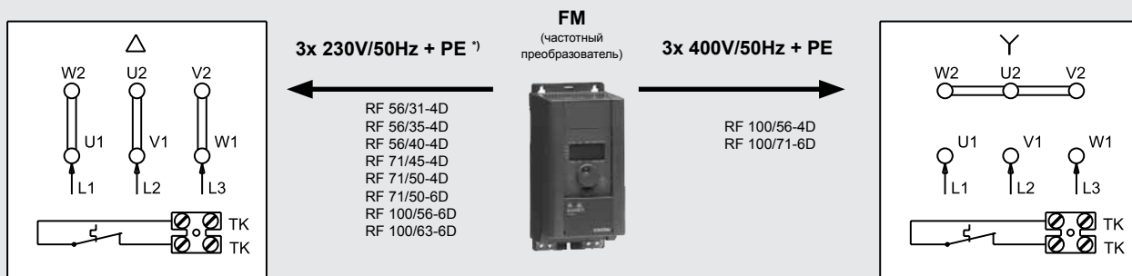
Рисунок 4 – включение Y/Δ на клеммнике трехфазного двигателя
